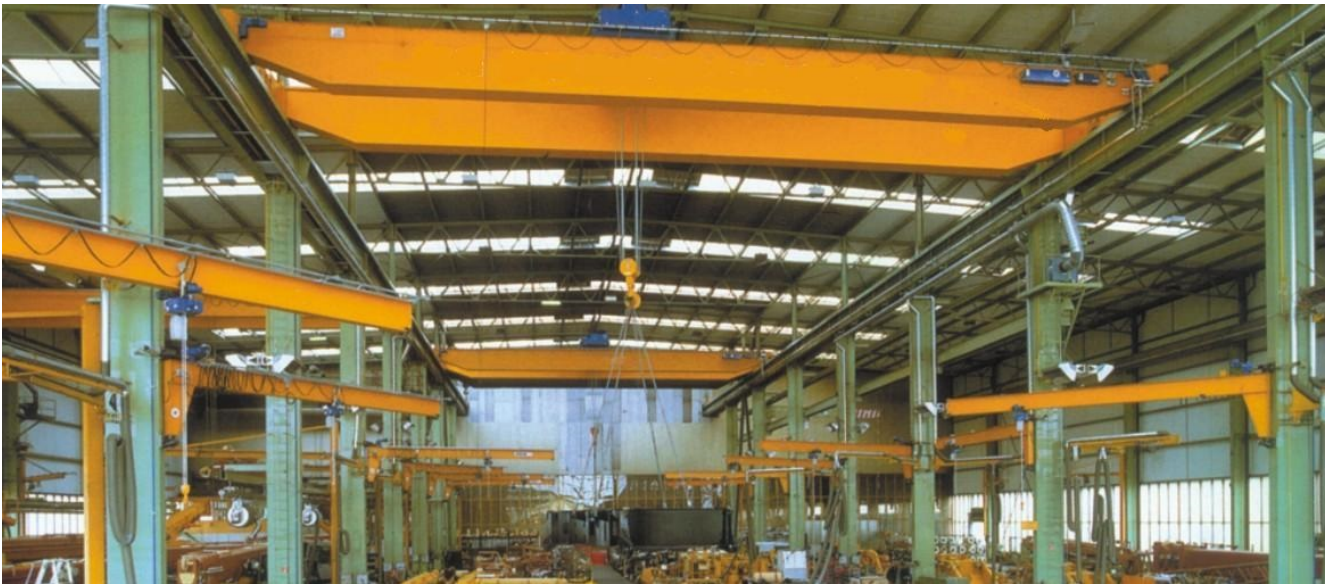
Suspended channel systems with manual translation. Appareils suspendus en profilé creux à glissière avec translation manuelle. Hängeanlagen mit Führungskanal und manueller Versetzung.
